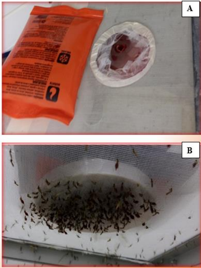
Figura 11 – Alimentador artificial utilizado nas alimentações sanguíneas de Aedes aegypti e Culex quinquefasciatus
