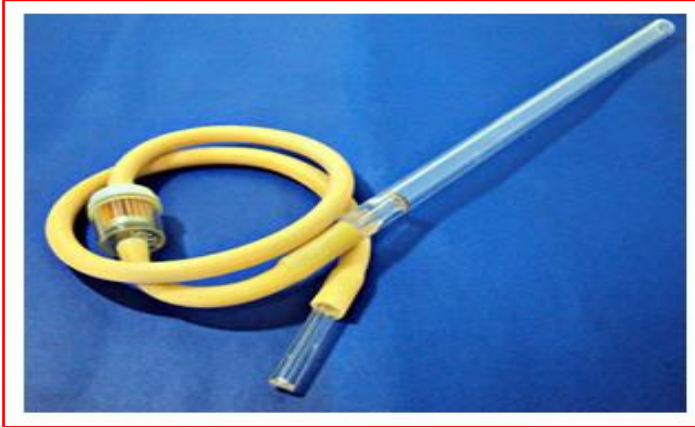
Figura 12 – Capturador de Castro para captura de mosquito
