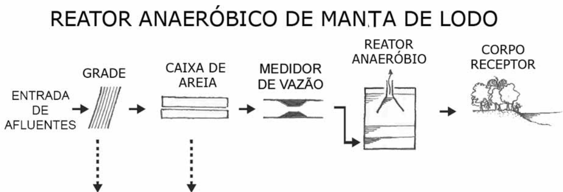
FIGURA 12: Desenho Esquemático da Utilização de Reator de Manta de Lodo (UASB)
