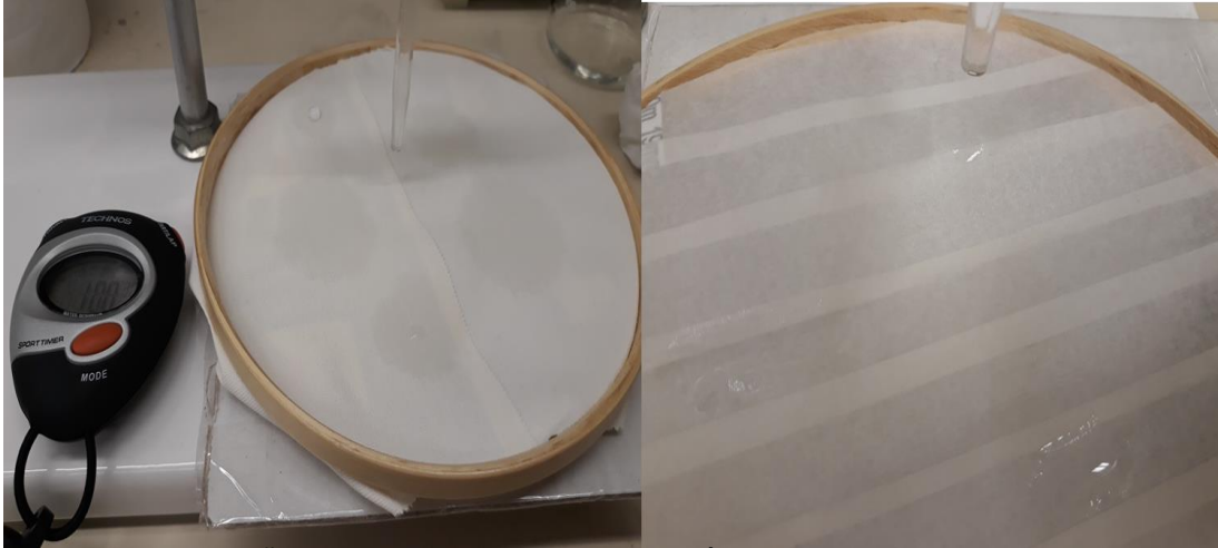
Figura 15 - Registro de imagens do resultado insatisfatório do ensaio de repelência à água para as fitas cirúrgicas de látex natural segundo as normas ABNT NBR 16506-1 e ABNT NBR 16506-2
