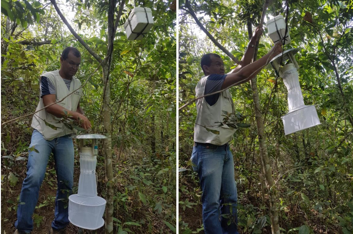
FIGURA 7: Instalação de armadilha do tipo CDC luminosa, com aditivo de CO 2 na caixa de isopor. Foto: Araujo-Oliveira 2019.
