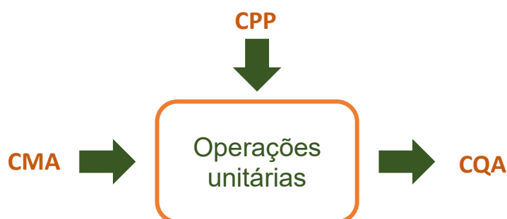
Figura 2. Relação do CMA e CPP com o CQA (adaptado de Yu et al., 2014).
