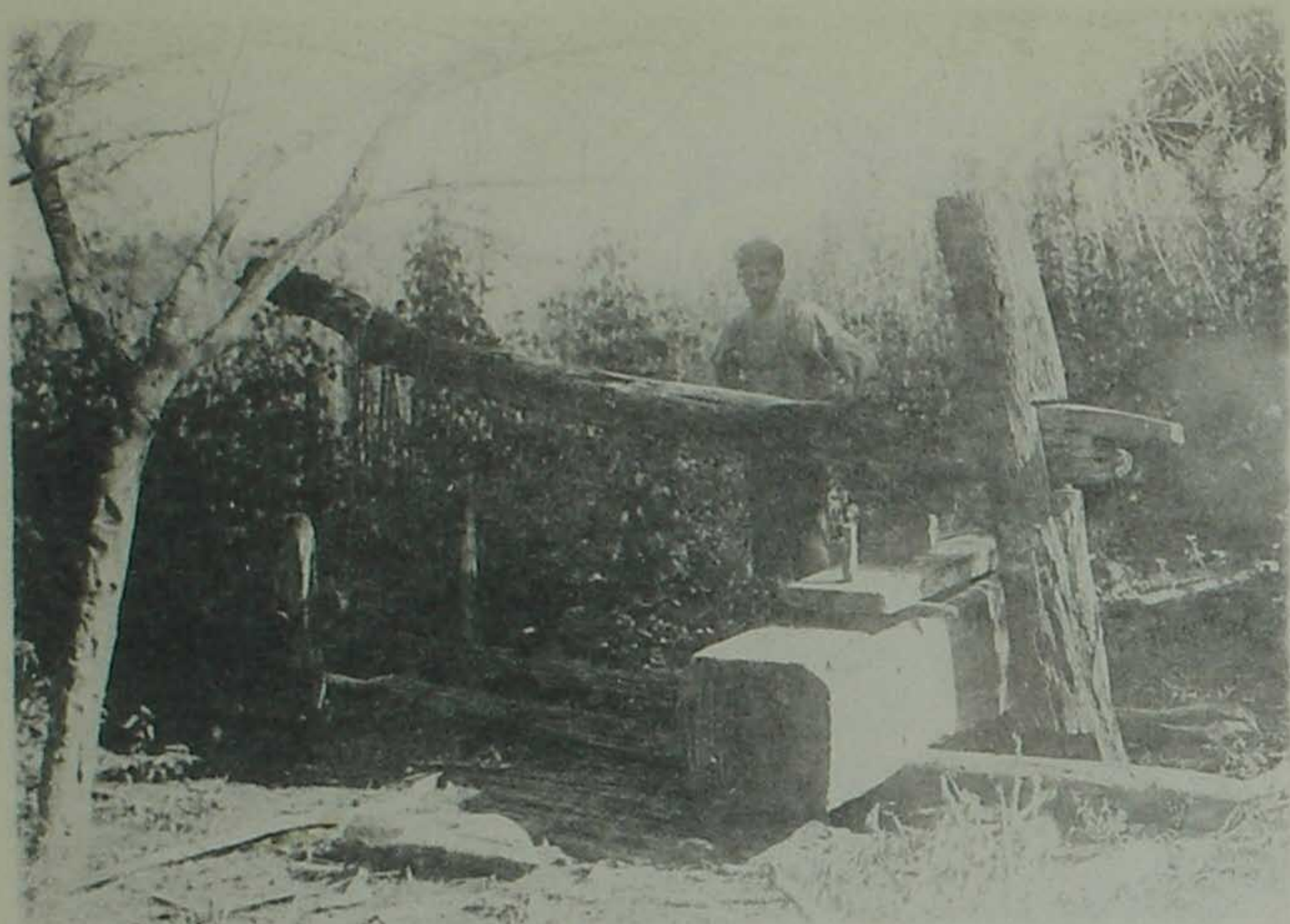
72—Prensa empregada no fabrico da farinha de mandioca—Tigre—Município de Petrolina—Pernambuco.
