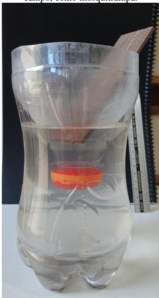
Figura 13 – Mosquitérica adicionada de uma palheta de Eucatex, para ser utilizada, em campo, como mosquitrapa.
