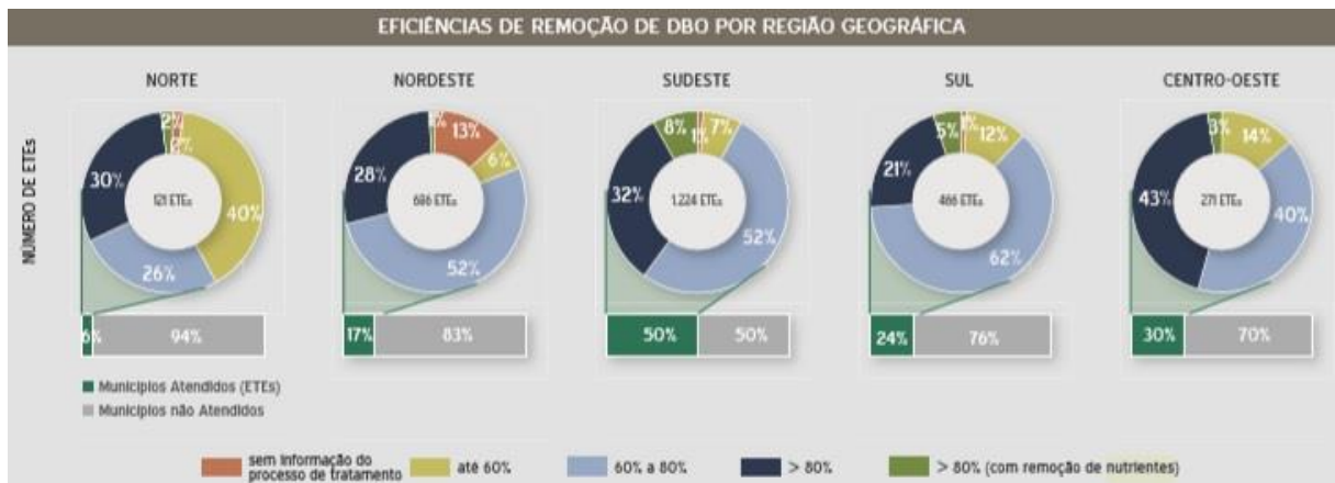
Figura 6. Percentuais de eficiências de remoção de DBO por região geográfica no Brasil.
