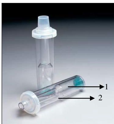
Figura 4.3. Concentrador Centriprep® YM-50, Millipore®. 1-Tubo coletor; 2- Recipiente externo para a amostra.
