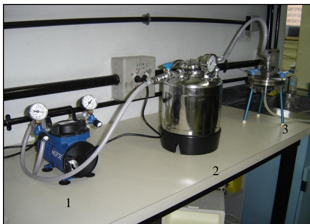
Figura 4.2. Sistema de filtração Millipore®. 1 - Bomba de vácuo com manômetros; 2 - Recipiente de pressão; 3 - Suporte de membranas.
