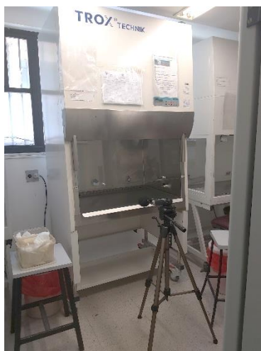
Foto 5 - Medições de NPS CSB 2 na Sala 116.
