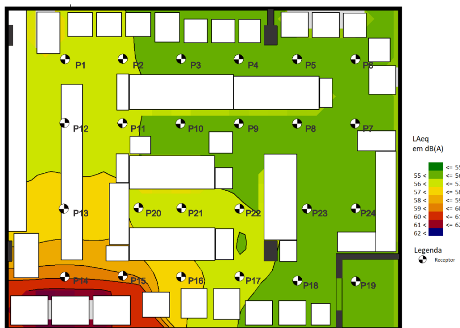
Figura 27 - Mapa de ruído gerado pelo Software SoundPlan para a condição de todas as Cabines de Segurança Biológica ligadas na Sala 525 acrescido de tratamento forro acústico.
