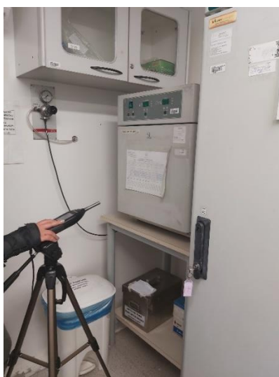
Foto 2 - Medições de NPS na Incubadora de CO 2 na Sala 116.
