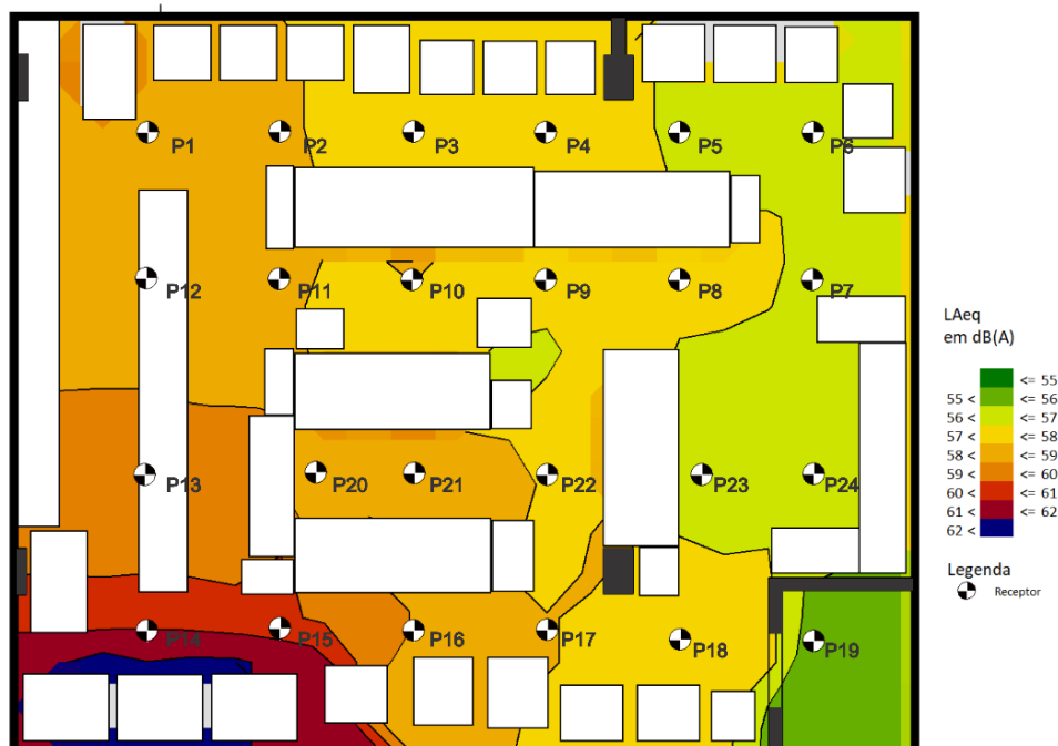
Figura 26 - Mapa de ruído gerado pelo Software SoundPlan para a condição de todas as Cabines de Segurança Biológica ligadas na Sala 525.
