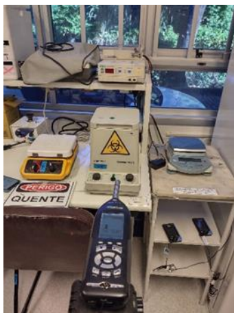
Foto 13 - Medições de NPS na Centrífuga na Sala 10b.
