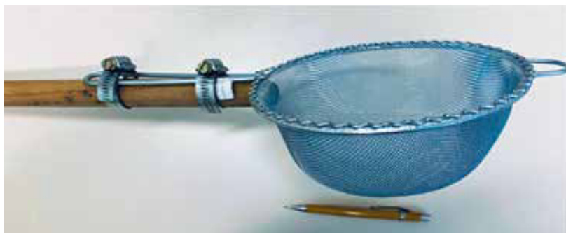
Figura 27. Peneira de metal, perfurada, com cabo de madeira, para coleta de caramujos de água doce.
