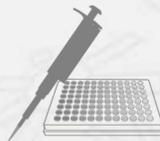
3. Adição de 100 µl de amostra (1:500) em poços duplicados, incubação em temperatura ambiente (30 min);
