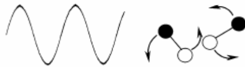
Figura 1.6. Molécula dipolar tentando se alinhar com um campo elétrico oscilante (LINDSTRÖM et al. 2001).
