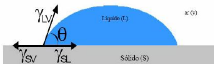
Figura 5.18. Representação esquematizada do ângulo de contato sobre uma superfície plana (adaptado de SMITH, 1980).
