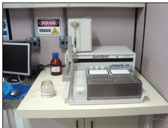
Figura 4.6. Sintetizador AutoSpot utilizado para a síntese do peptídeo contendo a sequência RGD.
