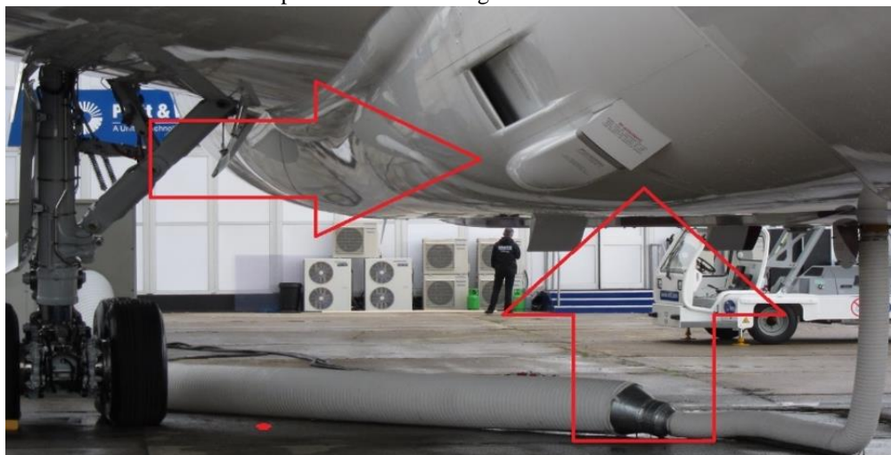
Figura 10: Entrada de ar do sistema de ar-condicionado do Boeing 787. Capta o ar diretamente da atmosfera e não realiza o procedimento de sangria de ar.
