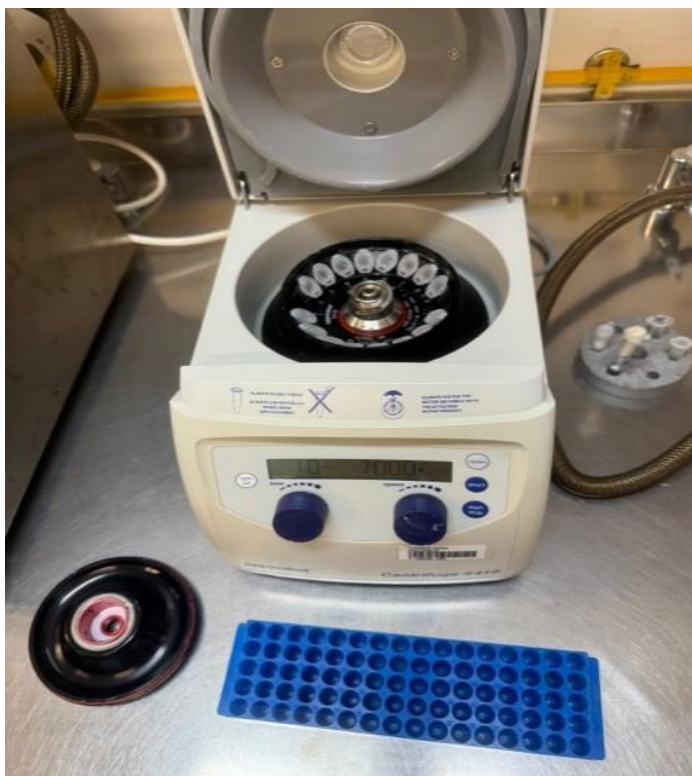
Figura 1 – Centrifugação das culturas a 7000 rpm por 10 minutos
