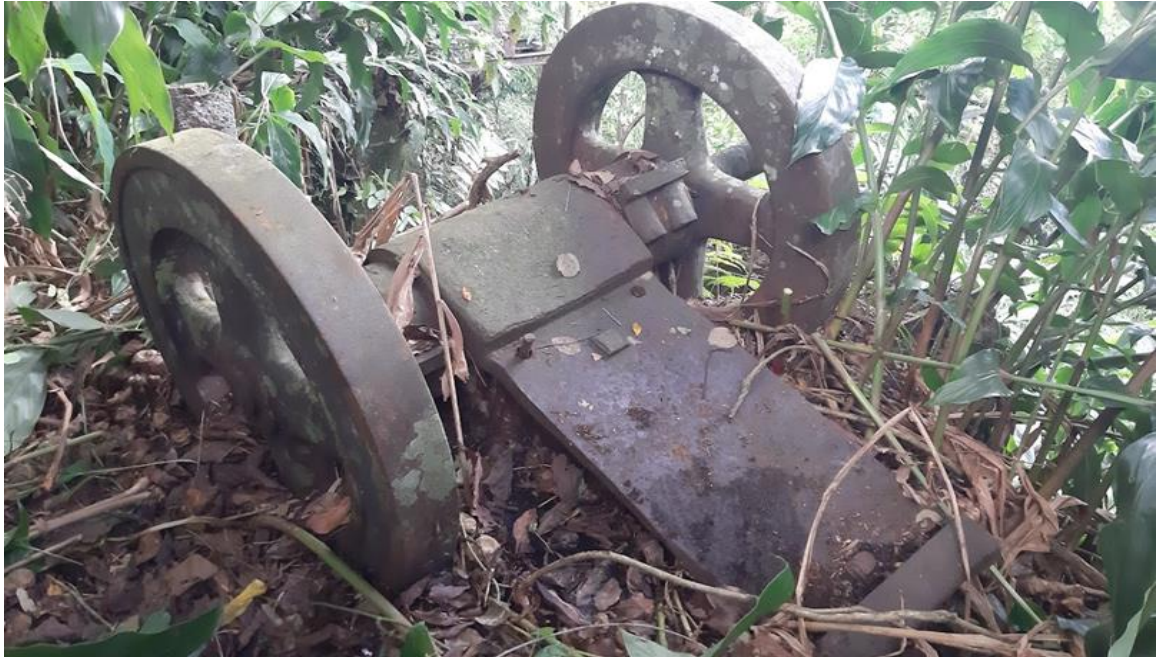
Figura 7 – Eixo excêntrico e rolamento do queixo do britador de mandíbulas. Fonte: Acervo pessoal da autora (2023)
