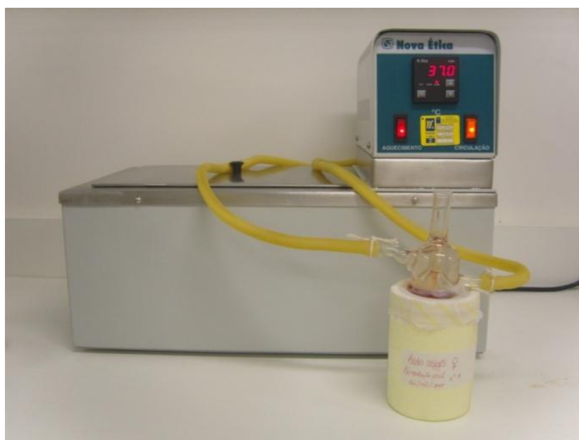
Figura 4.1. Alimentador artificial. Equipamento que permite a circulação de água a 37°C externamente à câmara de sangue, aquecendo-o.
