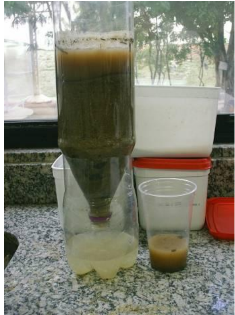
Filtração da água
