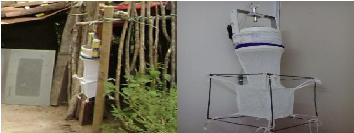
Figura 13: Armadilha do tipo HP para captura de insetos adultos. No alto uma lâmpada com um ventilador para sucção, na parte inferior uma gaiola para permanência/manejo dos flebotomos em laboratório. Fonte: Equipe do LIP.
