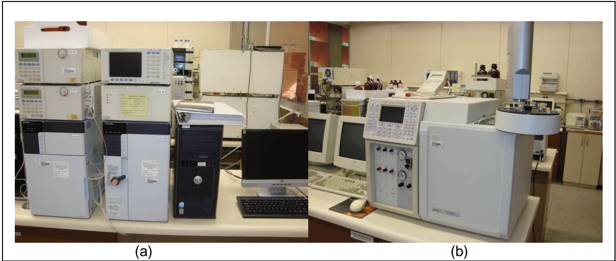
Figura 14: Equipamentos utilizados no perfil cromatográfico: (a): comatógrafo à líquido com detector UV/Vis com arranjos de fotodiodos; (b): comatógrafo à gas com detector
