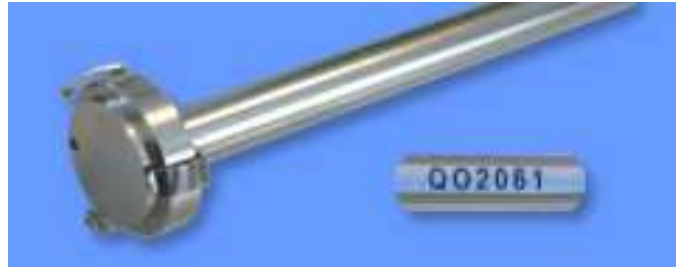
Figura 3 - Cesta e haste rotatória utilizada no método farmacopeico número 1.
