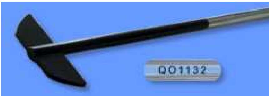
Figura 4 - Pá rotatória utilizada no método farmacopeico numero 2.
