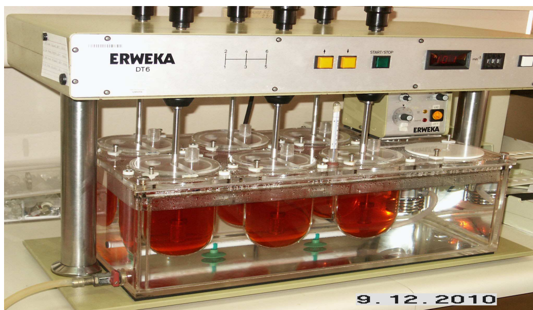
Figura 2 – Fotografia de um instrumento de dissolução ERWEKA DT6, montada com as cestas rotatórias.
