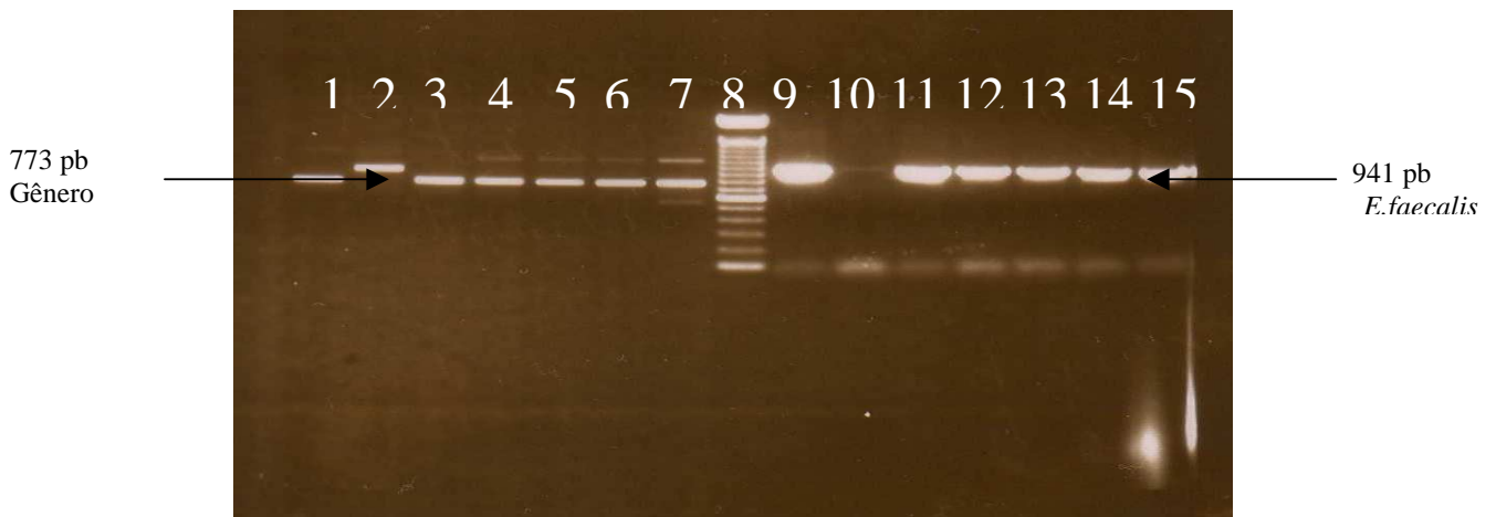
Figura 1: Foto ilustrativa de gel de agarose exemplificando os produtos da PCR para identificação do gênero Enterococcus e da espécie E. faecalis obtidos a partir dos isolados dos queijos Minas tipo fresco. Para gênero: 1: controle positivo de E. faecalis (SS1273); 2: controle negativo de Lactococcus (A6/1 com amplicom de 900 pb); 3: Q5/1; 4: Q5/2; 5: Q5/3; 6: Q5/4; 7: Q5/5; 8: Peso molecular 100 bp Ladder; Para espécie E. faecalis : 9: Padrão E. faecalis (SS1273); 10: controle negativo Lactococcus (A6/1); 11: Q5/1; 12: Q5/2; 13: Q5/3; 14: Q5/4; 15: Q5/5.
