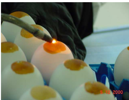
Figura 3.5 - Processo de carbonização da casca dos ovos.
