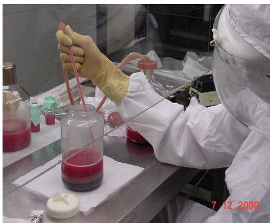
Figura 3.17 - Aspiração do sobrenadante .
