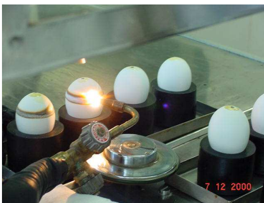
Figura 3.10- Anel de carbonização produzido com a chama de um maçarico.
