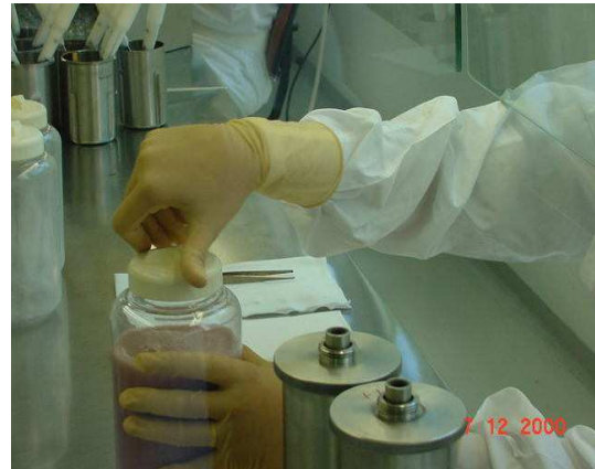
Figura 3.15 – Transferência do conteúdo de duas câmaras trituradoras para frasco de centrifugação.
