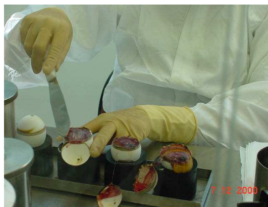
Figura 3.11 - Rebatimento da calota realizado com auxílio de espátula.
