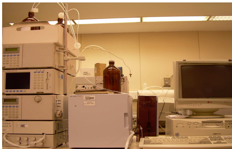
Figura 5 - Cromatógrafo líquido de alta eficiência, fabricante Shimadzu, modelo SPD 10AV com detector ultravioleta-visível e bomba LC-10AD. Programa usado para aquisição de dados Class-vp.
