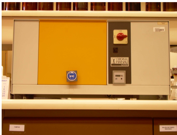
Figura 7 - Simulador solar – Suntest, fabricante Heraeus, potência 765w/m 2 , lâmpada NXE 1500A
